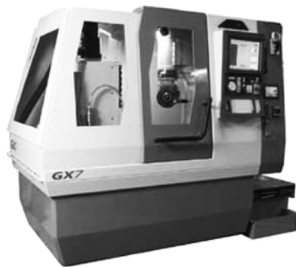
图8 昂科（ANCA）人造花岗岩床身工具磨床 [10]
