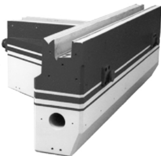
图2 斯图特高精度外圆磨床人造花岗岩床身
