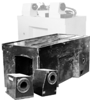
图13 北京机床研究所人造花岗岩基座主轴箱和尾座
